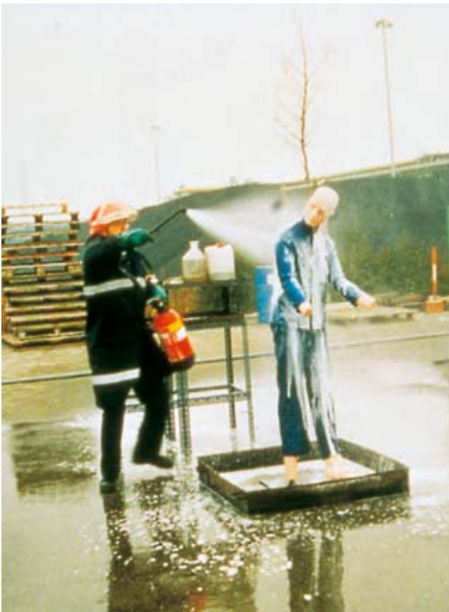
Bild 11-35: Ablöschen brennender Kleidung mit einem Feuerlöscher
